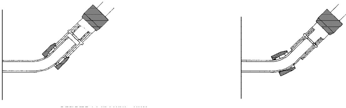
Anschließend wird der Lokring an die Kupplung herangeführt und die Montage kann aus der Richtung des äußeren Bogenradius durchgeführt werden. Ist auch nach diesem Verfahren keine ordnungsgemäße Montage möglich, muß der Stutzen entsprechend gekürzt und mit einer NAV-Verbindung versehen werden (siehe Punkt 1.11).
