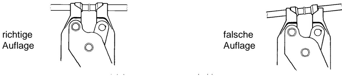
Während der Montage ist darauf zu achten, daß beide Rohre immer bis zum Anschlag in der Kupplung verbleiben. Deshalb die Lokringzange mit einer Hand nehmen, die andere Hand hält die Verbindung bis die Rohre eine bestimmte Vorspannung haben. Wenn die Verbindung fertig montiert ist, kann das Rohrsystem nach 3 Minuten evakuiert werden.
